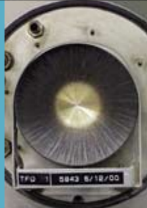
Wygląd tłoka po zastosowaniu tradycyjnego oleju
